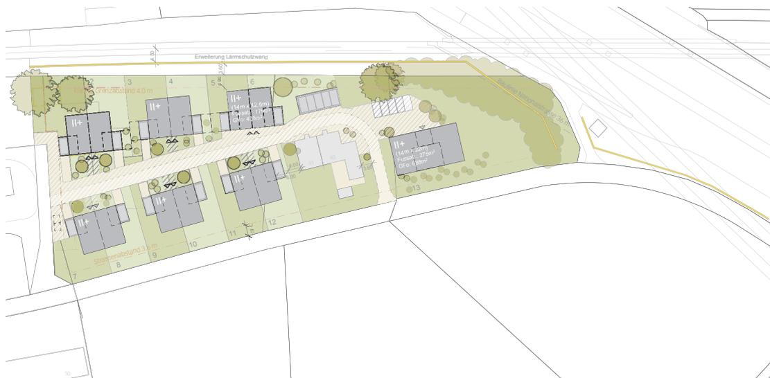
Abb. 8 Bebauungs- und Erschliessungskonzept mit Erweiterung Lärmschutzwand (gelb)
