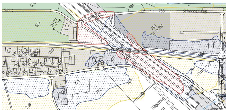
Abb. 3 Ausschnitt aus dem Zonenplan Naturgefahren mit Gefahrenggebiet geringe Gefährdung (gelb punktiert), mittlere Gefährdung (blau punktiert) und erhebliche Gefährdung (rot punktiert)
