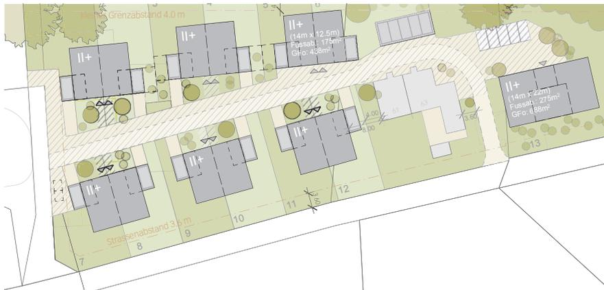
Abb. 16 Ausschnitt Bebauungs- und Erschliessungskonzept mit geplanter Detailerschliessung
