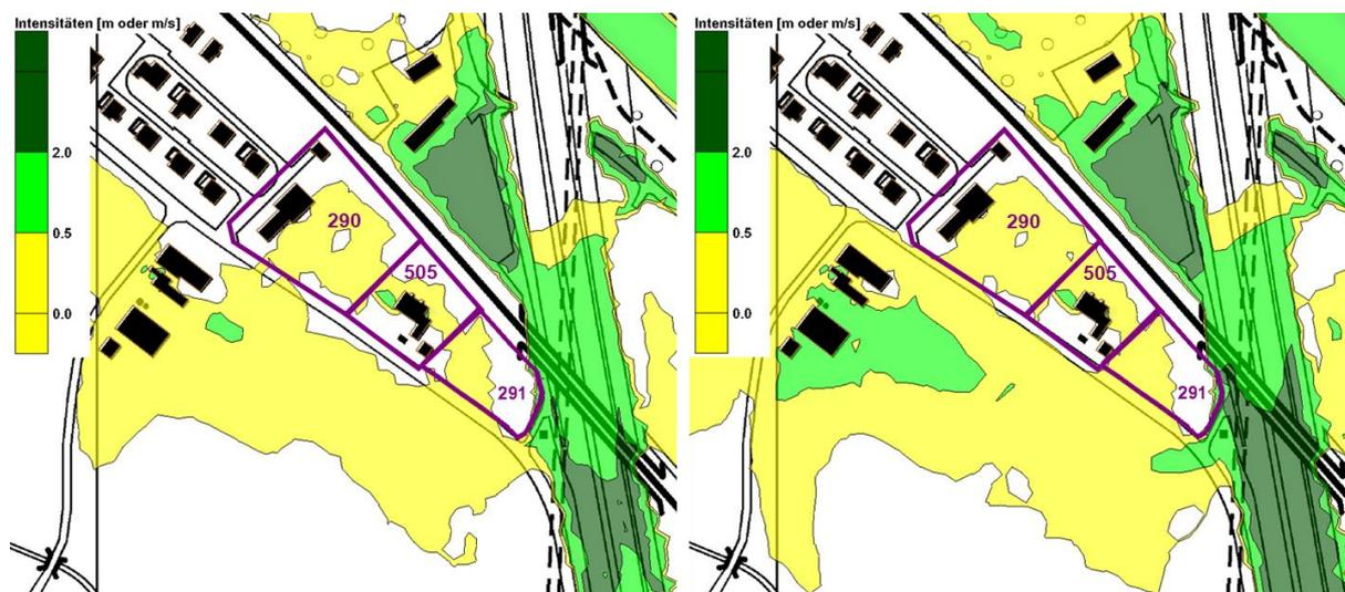
Abb. 1: Ausschnitt aus den Überflutungsberechnungen aus dem Jahre 2019: Intensitäten (Maximum aus  $h$  und  $v \cdot h$ ) bei einem  $HQ_{100}$  (links) und  $HQ_{300}$  (rechts).
