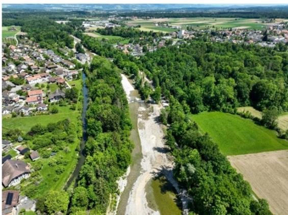
Bild 5: Sohlenaufweitung oberhalb Emmenbrücke Seite Utzenstorf
